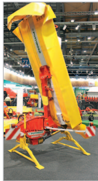
Žací stroj NovaCat 352 V není vybaven kondicionérem. K jeho pohonu stačí traktor o výkonu 80 k. Písmeno „V“ na označení stroje poukazuje na novou možnost vertikální transportní polohy Foto Petr Beneš
