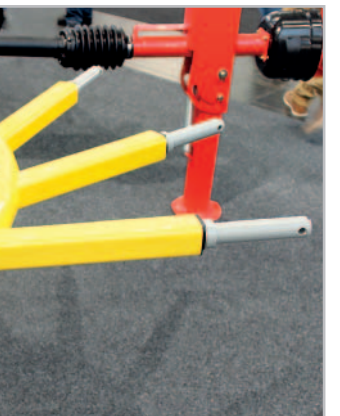
Rotory TopTech Plus u shrnovačů mají prachotěsnou konstrukci a velmi malé nároky na údržbu. Ramena jsou snadno demontovatelná Foto Petr Beneš
