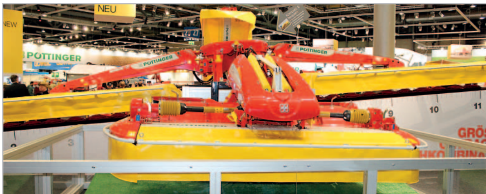
Největší žací kombinace na trhu NovaCat S12 váží jen o něco málo přes 2000 kg a pro agregaci požaduje traktor o výkonu 160 k. Elektrohydraulicky lze samostatně ovládat zdvih u každého stroje Foto Petr Beneš
