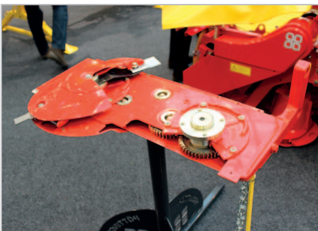
Žací nosník strojů NovaCat má inovovaný pohon – ozubená kola mají špičatější zuby, v záběru jsou vždy tři z nich. Díky tomu se točivý moment může rovnoměrněji rozložit Foto Petr Beneš
