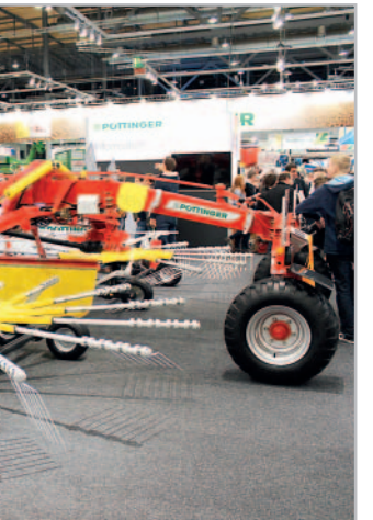
Dvourotorový shrnovač Top 842 C je vhodným spojením velkého záběru, rovnoměrného středového formování řádku a obratnosti dané malou délkou a podvozkiem s řízenou nápravou Foto Petr Beneš
