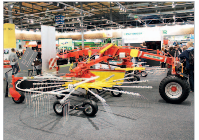
Dvourotorový shrnovač Top 842 C je vhodným spojením velkého záběru, rovnoměrného středového formování řádku a obratnosti dané malou délkou a podvozkiem s řízenou nápravou Foto Petr Beneš
