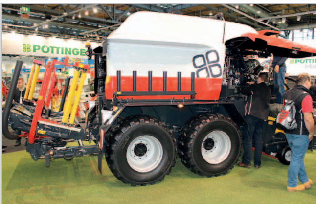
Největší novinkou expozice firmy Pöttinger na veletrhu Agritechnica byly lisy nové generace s označením Impress. Existují v provedení s pevnou i variabilní lisovací komorou, případně jako kombinace na jednom podvozku včetně baličky Foto Petr Beneš
