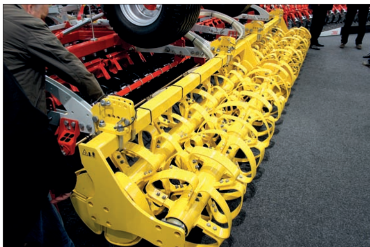
Terradisc 6001 T prezentoval nový typ zdvojeného kónického segmentového válce, který vyniká vysokou nosností. Díky tomu je vhodný pro návěsná provedení strojů, u nichž zvyšuje přítlak na talíře ještě sklopený podvozek. Zešikmené tvarování jednotlivých segmentů podporuje samočisticí funkci
