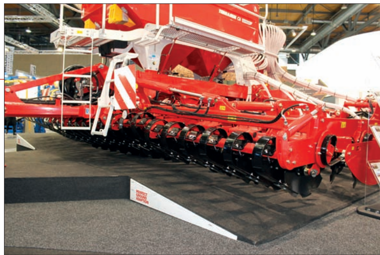
Pneumatické secí stroje Terrasem C dokážou i se svým záběrem až do 9 m dobře kopírovat pozemek díky výkyvnému spojení bočních sekcí s talíři, opěrným a pojezdovým pneumatikovým válcem a sekcí secích botek
