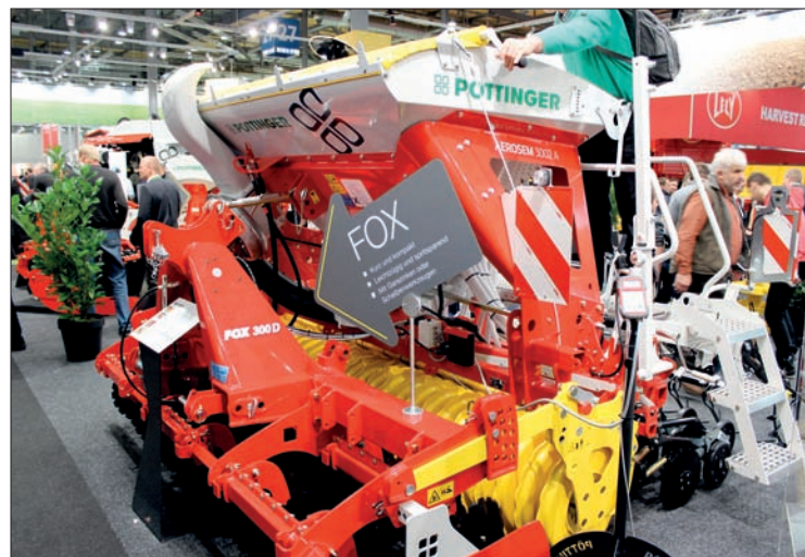
Pneumatický secí stroj Aerosem 3002 A v jednodušším provedení představil zajímavou agregaci s krátkou kombinací FOX 300 D (se dvěma řadami talířů). Secí kombinace má velmi kompaktní rozměry a nižší náročnost na zvedací kapacitu zadního tříbodového závěsu traktoru
