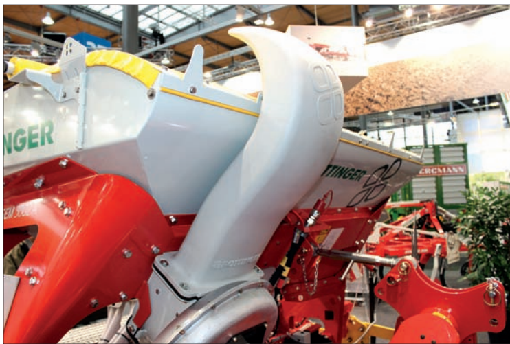
Pro sezónu 2016 budou pneumatické secí stroje Aerosem A standardně vybavovány tímto „límcem“, díky kterému je nasáván vzduch z oblasti s nízkou prašností
