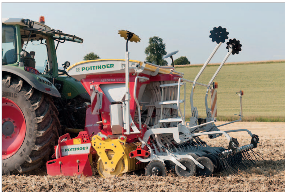
Ve výbavě s rozdělovací hlavou IDS je možné provádět z kabiny nastavení rozteče kolejových meziřádků či jejich šířky podle potřeby. Toto pohodlí ocení každý uživatel zvláště při poskytování služeb Foto archiv
