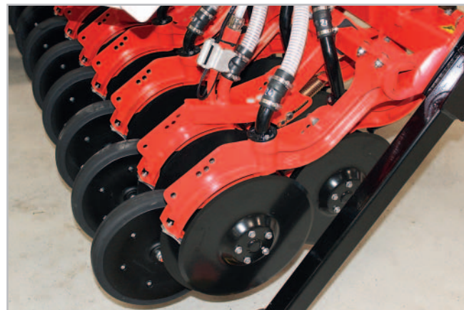
Secí botky pro výsev kukuřice jsou vybaveny optickým senzorem, který kontroluje procházející zrna. V případě odchylky vyšle upozornění Foto Petr Beneš
