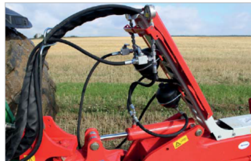
Systém Traction-Control pro přidavné dotížení zadní nápravy traktoru se velmi osvědčil a jeho přínos je znát. Kromě něj v Jetřichovci využívají také možnost vychýlení prvního orebního tělesa mimo záběr
