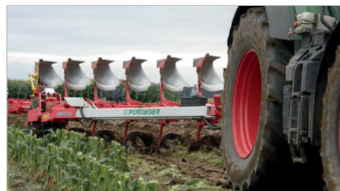
Pluh Servo 6.50 firmy Pöttinger zore ročně v průměru tisíc hektarů, někde do hloubky až 27 cm. Spotřeba přitom nepřekračuje 20 l/ha
