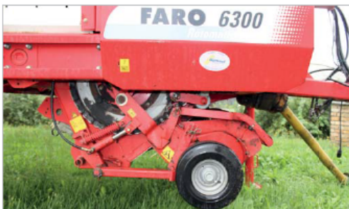
Návěsy Faro mají plnicí válec poháněný jednoduchým válečkovým řetězem. Dostatečně dimenzovaná robustní převodovka se šikmými ozubenými koly zajišťuje spolehlivý přenos výkonu od traktoru pro plynulé plnění i při sběru značně nerovnoměrných řádků
