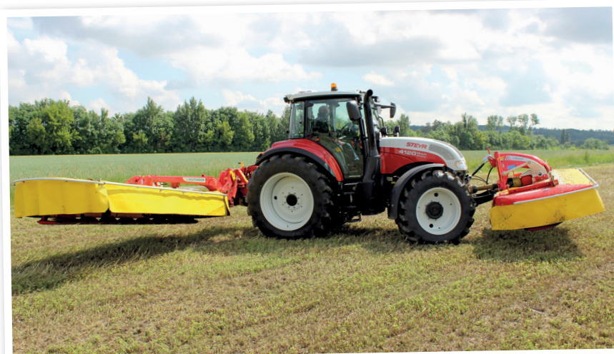
Traktory řady Multi mají malý poloměr otáčení na úrovni pouze 4,05 metru. Jejich celková dovolená hmotnost je zvýšená na 8 t a na přání mohou být vybaveny odpružením kabiny
