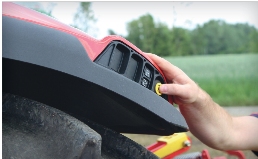
Nově je u traktorů Multi možné ovládat zadní vývodový hřídel a tříbodový závěs také externě na obou zadních blatnících
