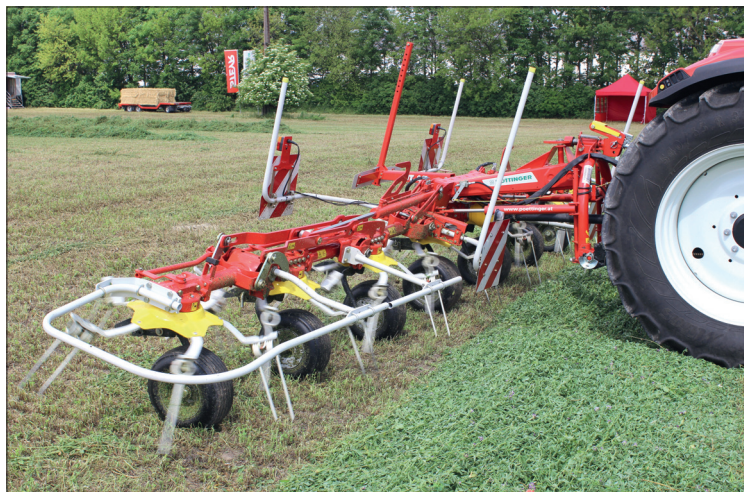
Obraceč HIT 8.81 firmy Pöttinger je konstruován tak, že v průběhu otáčení na souvrátích se ve zdvižené poloze krajní rotory neprověšují a nedochází tak ke kontaktu jejich prstů s půdou
