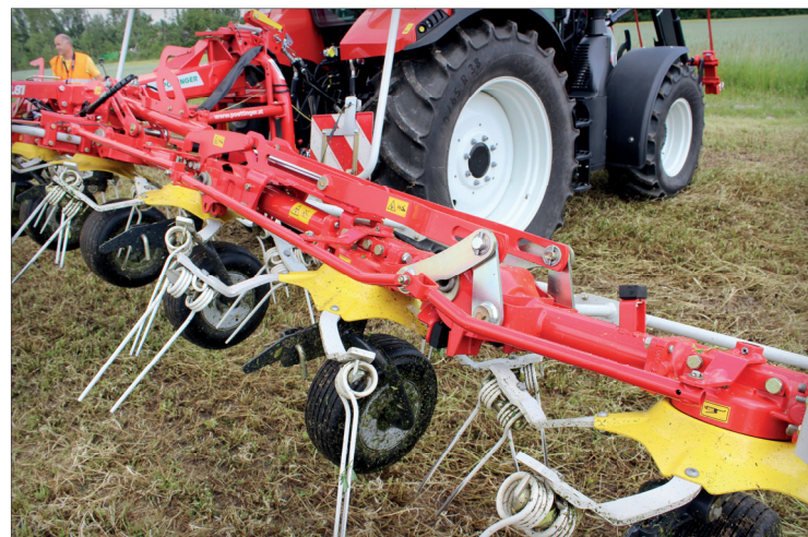
Tyč za rámem obrabeče spojuje kolečka pod jednotlivými rotory. Řidič traktoru tak může z kabiny centrálně ovládat jejich natočení pro optimální distribuci píče na členitých pozemcích
