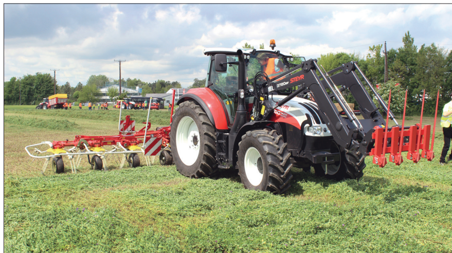
U řady Multi existuje možnost vybavit traktor čelním nakladačem Steyr přímo z výroby. Ovládání usnadní nový joystick a nastavitelná agresivita reverzace
