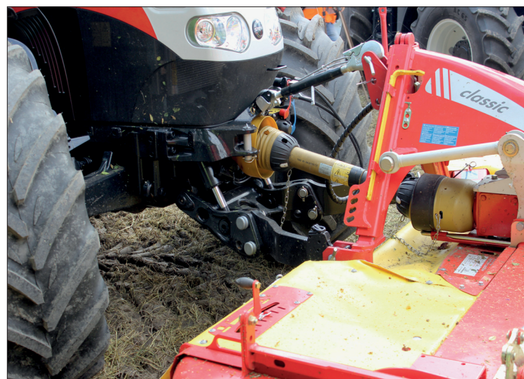
Nově je u traktorů Multi možné ovládat zadní vývodový hřídel a tříbodový závěs také externě na obou zadních blatnících
