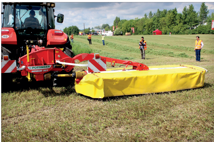
Bočně nesený žací stroj Pöttinger NovaCat 352 V s pracovním záběrem 3,46 m je osazen osmi žacími disky. Vysokou průchodnost podporují kuželové plochy na žacích discích a kopírování půdy je umožněno osvědčeným středovým zavěšením. Pro přepravu se stroj vyklápí vertikálně v úhlu 115 stupňů přes osu traktoru, čímž je zajištěna nižší dopravní výška i stabilita soupravy
