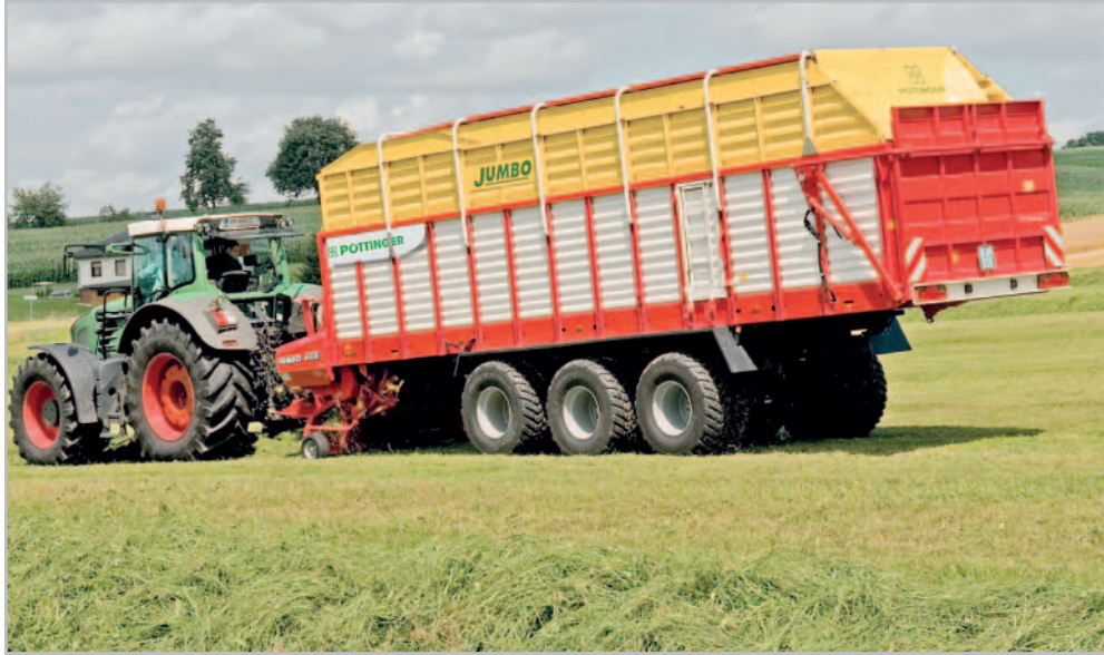
Senážní návěs Jumbo 10010 L je vhodným strojem pro sklizeň velkých objemů zavádlé píce v krátkém čase. Ve svém řezacím ústrojí má 45 nožů, které píci zkracují na řezanku s teoretickou délkou 34 mm Foto Petr Beneš
