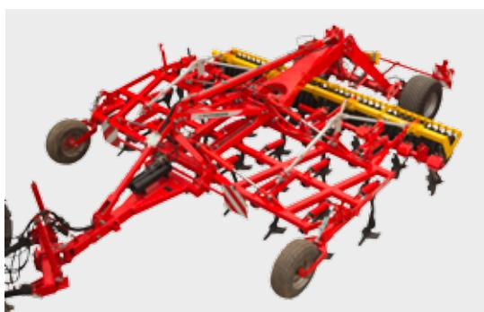
Přepravní podvozek slouží k tomu, aby zvedací mechanismus a zadní náprava traktoru nebyly přetíženy. V průběhu práce na poli je podvozek zvednutý, čímž dosáhneme dodatečného zatížení pracovních nástrojů – kvalitní práce i na suchých a tvrdých půdách. **SYNKRO** s podvozkem pro bezpečnost při dopravě i při agregaci s traktory nižších výkonových tříd. Automatické zajištění pracovních orgánů při dopravě.
