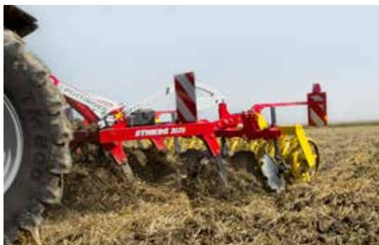
**Krátká konstrukce je charakteristickým znakem těchto podmítáčů. Stroje jsou vhodné pro traktory nižší hmotnosti a zvedací síly.**
