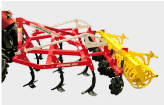
**Stroje řady 1030 jsou vhodné pro mělké i hloubkové zpracování půdy při agregaci s traktory s minimálním výkonem 100 k.**
