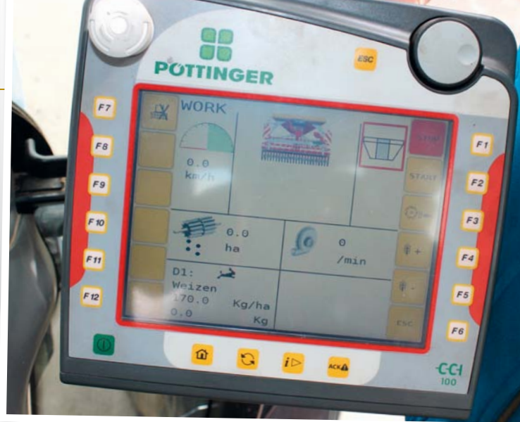
Pro nastavení a ovládání secího stroje slouží ISO-Bus terminál CCI 100 s prostornou dotykovou obrazovkou. Zadává se zde též výsevek či případně dávka hnojiva
