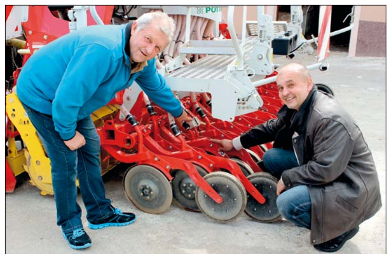
„Přestavbu na výsev kukuřice jsem zvládl sám během třiceti minut, pohyb zrn ke čtyřem secím botkám kontrolují tyto senzory,“ vysvětluje spokojeně Jan Gut (vlevo). „Kromě výsevního ústrojí PCS je to další chytré řešení našeho nového secího stroje,“ dodal Ing. Zdeněk Bílý
