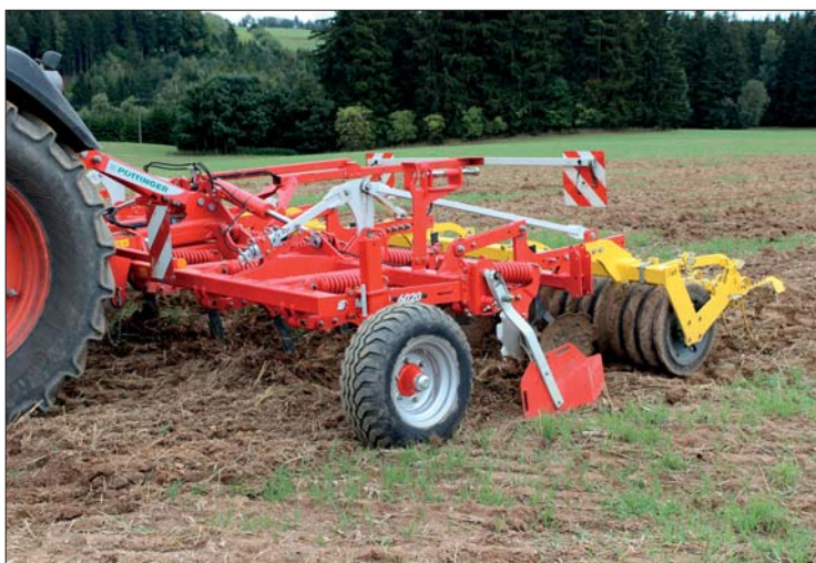
Posledním z testovaných strojů byl dvouřadý radličkový kypřič Synkro 6020 K Nova. Stroj vyniká kompaktními rozměry, snadným ovládnutím i nastavováním a jednoduchou údržbou
