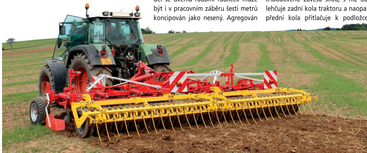
I přes dvouřadé provedení provádí kypřič Synkro 6020 celoplošné podříznutí půdy v celém záběru a její promísení s organickou hmotou a vzešlým výdrolom
