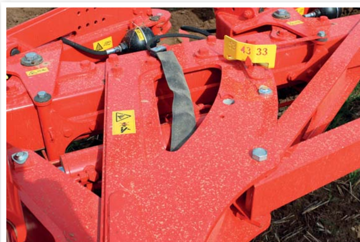
Pluh Servo 6.50 Nova Plus byl vybaven hydropneumatickým jištěním orebních těles proti přetížení a systémem plynulé změny záběru těles, s nímž byl celkový záběr nastaven na rovné tři metry
