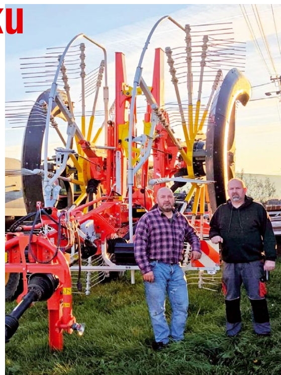
Na snímke zľava Pavol a Stanislav Bartošovci so zhrabovačom TOP 882 C FLOWTAST. Má vyššiu priechodnosť a plastové plazy majú v porovnaní s kopírovacími kolesami niekoľko nesporných výhod, napríklad už nehrozí defekt.
