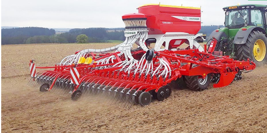
Univerzální secí stroj TERRASEM C6 pracuje na farmě sedmou sezonu a dokáže set do mulče, zorané půdy i přímo do strniště. V jednom přejezdu spojuje přípravu půdy, utužení, přesný výsev a zpětné zpevnění řádků.
