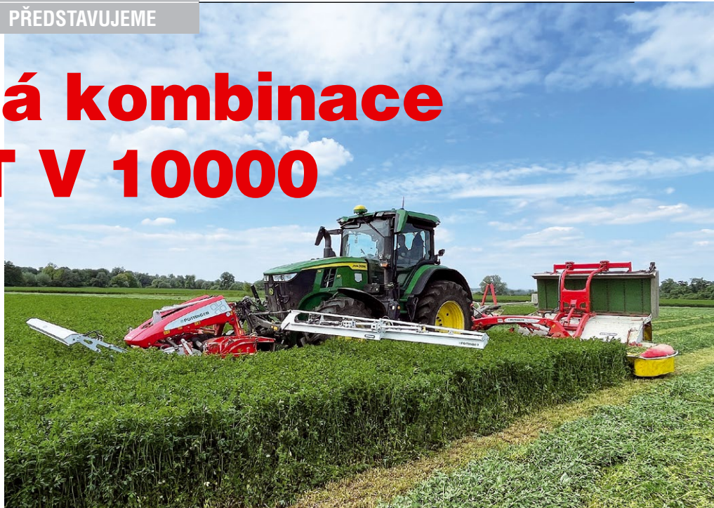
Disková žací kombinace nasazená v ŠZP Žabčice MU Brno. Kombinace NOVACAT 301 ALPHA MOTION ED PRO a NOVACAT V 10000 ED COLLECTOR je vybavená prstovými kondicionéry, shazovacími pásy a zařízením pro detekování divoké zvěře SENSOSAFE.
