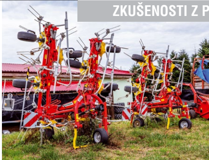
Čelní kopírovací kolečko dodržuje nastavenou výšku prstů a umožňuje kvalitní kopírování nerovností terénu.
