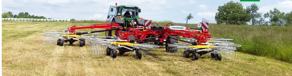
Štvorrotorový stredový zhrňovač krmovín TOP VT 12540 C kombinuje vysokú plošnú výkonnosť, kopírovanie nerovností s vynikajúcou manévrovateľnosťou a stabilitou. Ideálny je aj pre prácu vo svahovitom teréne.
