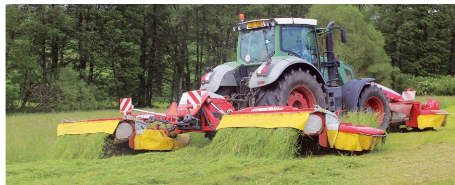
Žací kombinace NOVACAT A10 ED s čelní lištou NOVACAT 351 F ED ALFA MOTION má nastavitelný pracovní záběr až deseti metrů. Posečenou hmotu odkládá do řádků nebo ji rovnoměrně rozhodí po celé šířce záběru.
