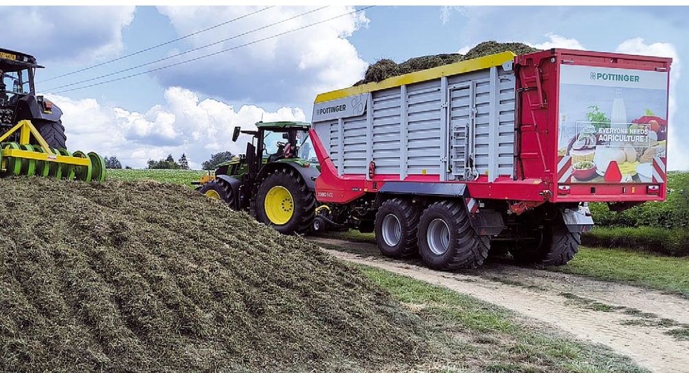
Senážní vůz JUMBO 8400 s počtem 65 asymetricky uspořádaných nožů s roztečí 25 mm umožňuje sklizeň píče v nejvyšší kvalitě. Řezanka je optimální, dobře se rozpadá a bez potřeby dalšího rozhrnování.
