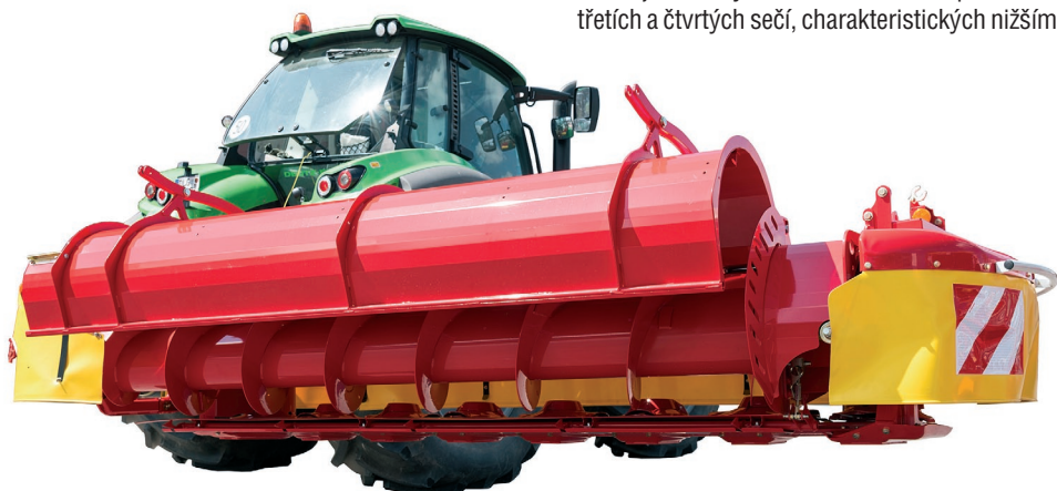
Jednoduchým zvednutím zadního krytu dopravníku je možné docílit toho, že píce je odkládána na široko. Po sklopení krytu posouvá dopravník veškerou hmotu ke středu, přičemž díky od sebe vzdáleným závitům má vysokou průchodnost.
