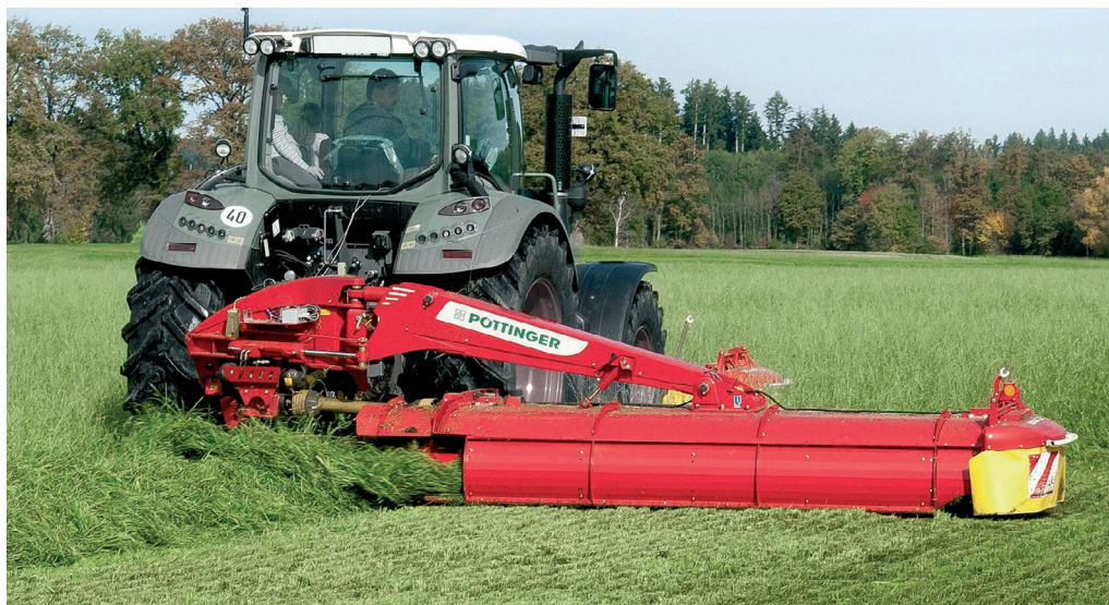
Žací stroj NOVACAT 352 CF je díky svému šetrnému působení na píci a bezztrátovosti sklizně vhodný nejen pro louky, ale i pro sklizeň hrachu, jetelovin či ozimých obilnin na GPS. Dopravník také eliminuje riziko případného znečištění píce při shrnování.
