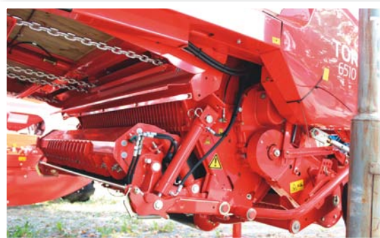
Nosník nožů lze nyní vykloupat stiskem jednoho tlačítka na levé straně vozu. Nože mohou být v provedení s jedno- nebo oboustranným ostrím. Podlahový dopravník je v přední části skloněn o 150 mm dolů
