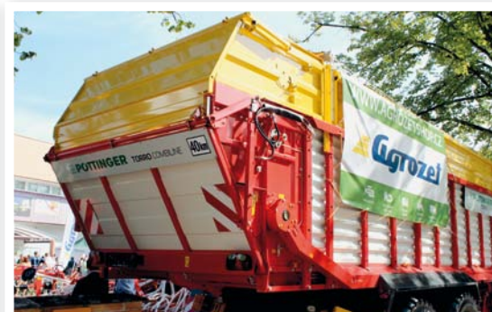
Na přání mohou být nové návěsy Torro Combiline vybaveny rozduřovacími válci. Jejich pohon je bezpečně ukrytý na pravé straně vozu. Nikoli po stranách, ale přímo uprostřed se nachází hydromotor pro pohon podlahového dopravníku
