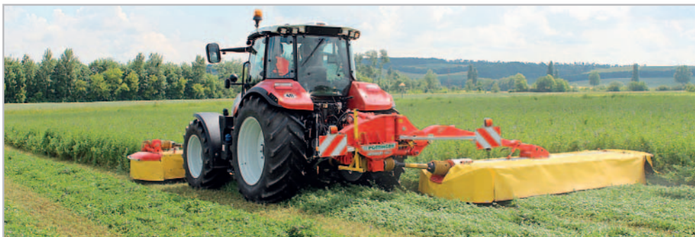
Bočně nesený žací stroj Pöttinger NovaCat 352 V s pracovním záběrem 3,46 m je osazen osmi žacími disky. Pro přepravu se stroj vyklápí vertikálně v úhlu 115 stupňů přes osu traktoru, tím je zajištěna nižší dopravní výška
