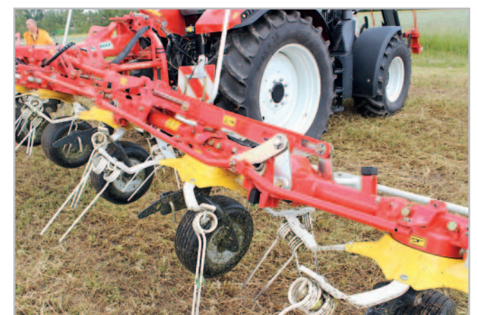
Tyč za rámem obrabeče spojuje kolečka pod jednotlivými rotory. Řidič traktoru tak může z kabiny centrálně ovládat jejich natočení pro optimální distribuci píce na členitých pozemcích
