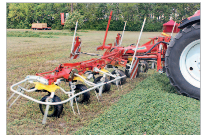
Obrabeč HIT 8.81 firmy Pöttinger je konstruován tak, že v průběhu otáčení na souvratích se ve zdvižené poloze krajní rotory neprověšují, a nedochází tak ke kontaktu jejich prstů s půdou
