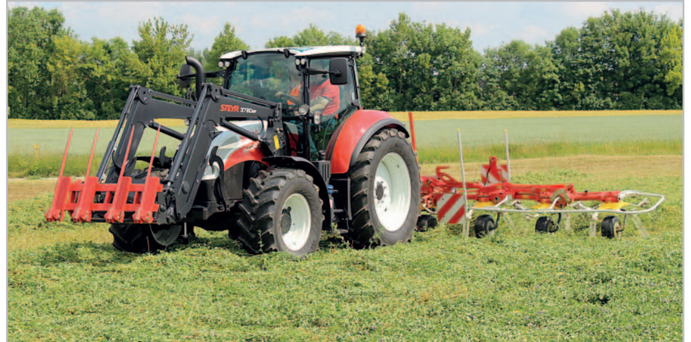
U řady Multi existuje možnost vybavit traktor čelním nakladačem Steyr přímo z výroby. Ovládním usnadní nový joystick a nastavitelná agresivita reverzace
