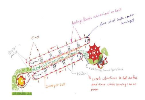
Bei dieser Idee übergibt die Pick-Up das Gras an zwei vibrierende Förderbänder, welche mit Zinken bestückt sind. Durch die Zinken bilden sich kleine Hohlräume zwischen den Förderbändern. Auf Grund der Vibrationen der Förderbänder richtet sich das Gras aus und kann anschließend an das Schneidwerk übergeben werden.
