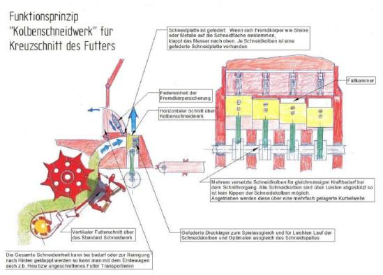
Bei dieser Idee werden nicht die Halme ausgerichtet, um eine bessere Futterqualität zu erreichen, sondern das Gras mittels eines alternativen Kolbenschneidwerks geschnitten. Nachdem das Gras durch das konventionelle Schneidwerk vertikal in Futterpakete geschnitten wurde, wird es durch ein Kolbenschneidwerk zusätzlich horizontal geschnitten.
