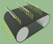
Die Pick-Up wird durch ein Förderband, auf dem sich Zinken befinden, ersetzt. Diese Zinken nehmen das Futter vom Boden auf. Mit Hilfe von kleinen Schaufeln oder auch Kämmen werden die aufgenommenen Futterpakete verdichtet – so sollten sich die Grashalme entlang der Zinken ausrichten. In weiterer Folge schwenken die Kämme bzw. Schaufeln wieder aus und das Futter kann an das Schneidwerk übergeben werden.
