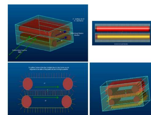
Die Pick-Up wird durch zwei Förderbänder ersetzt, wobei das untere Förderband weiche Zinken und das obere harte Zinken hat. Die Förderbänder laufen mit unterschiedlicher Geschwindigkeit, dabei überholen die oberen Zinken die unteren. Die Grashalme werden dabei, ähnlich wie beim Kämmen von Haaren der Länge nach ausgerichtet.
