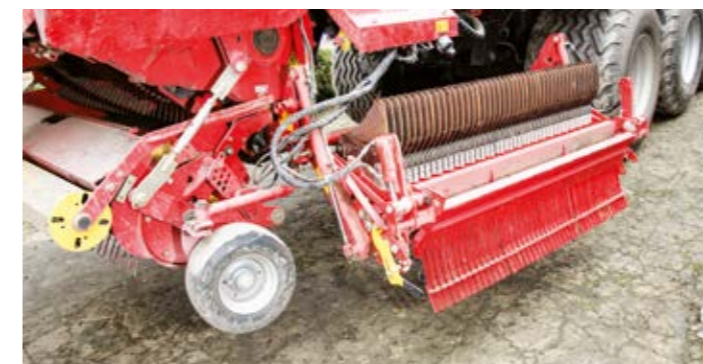
Pełna kontrola belki nożowej jest możliwa po jej odchyleniu na lewą stronę maszyny.
