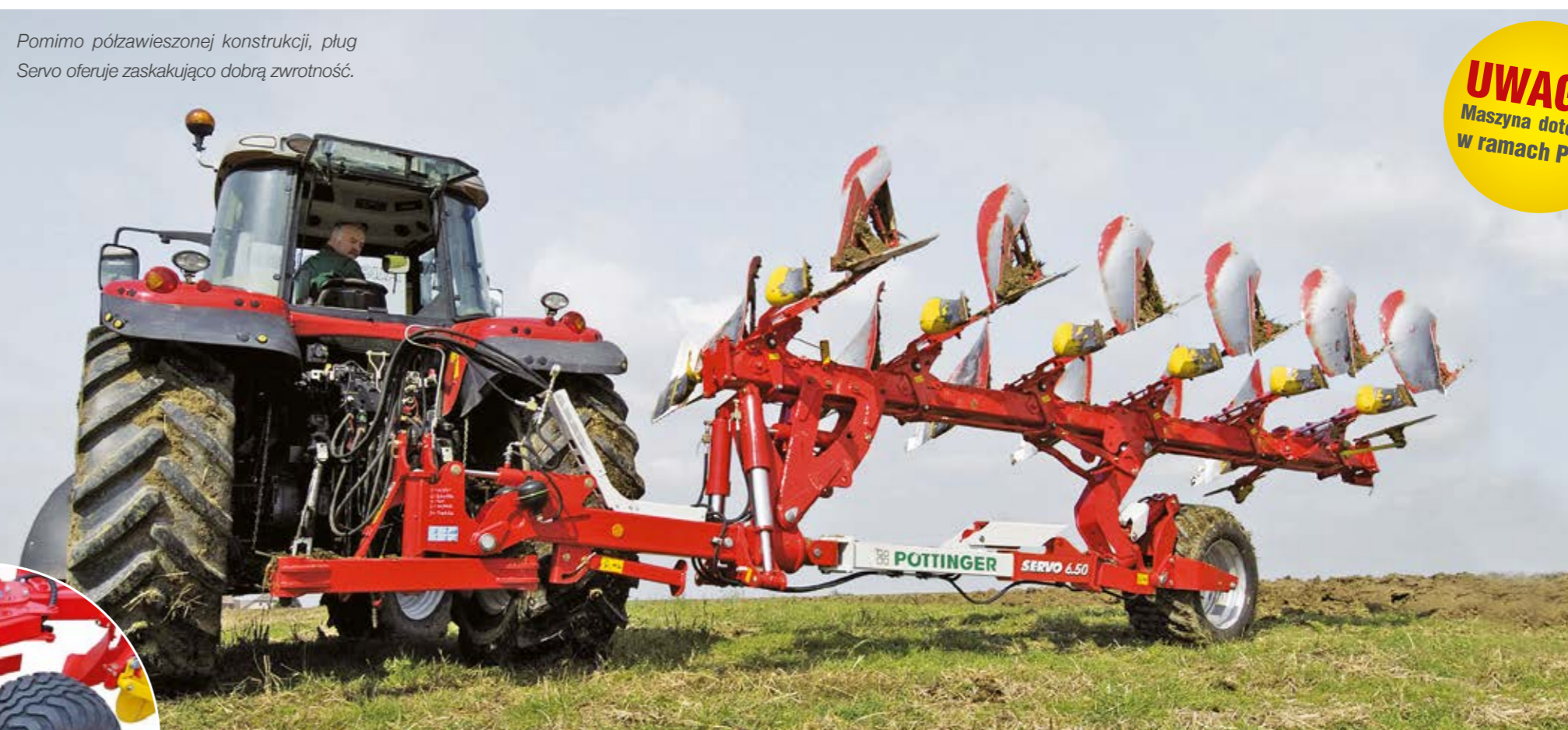
Optymalne ustawienie punktu ciągu skutkuje prawidłowym prowadzeniem ciągnika w bruzdzie przez pług, co przekłada się na ograniczenie zużycia maszyn i paliwa.
