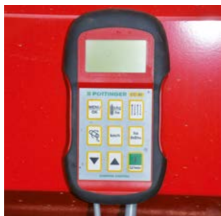
Sterownik Compass umożliwia wygodną obsługę maszyny z kabiny ciągnika.
