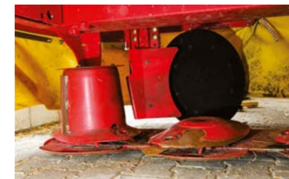
Tarcze zwięzające pokos przekierowują skoszoną masę między koła ciągnika.
