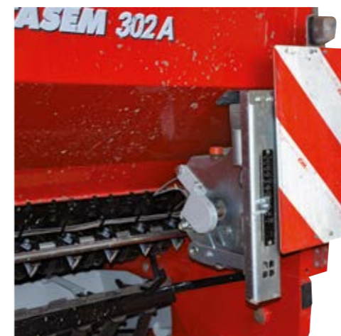
Elektryczne sterowanie dawką wysiewu pozwala na płynną regulację podczas pracy. Na zdjęciu widoczny wskaźnik wypełnienia zbiornika.
