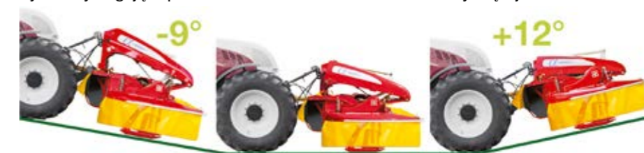
Zawieszenie ALPHA MOTION pozwala na płynny ruch listwy nożowej we wszystkich kierunkach, co przekłada się na doskonałą jakość kopiowania terenu i czystość paszy.
