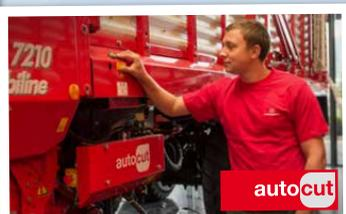
Mit nur einem Knopfdruck wird der komplette Schleifvorgang ausgeführt.
