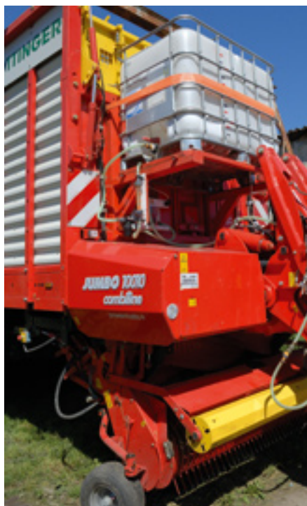
Vozy JUMBO jsou vybaveny aplikátory konzervačních přípravků pro zlepšení kvality objemných krmiv.
