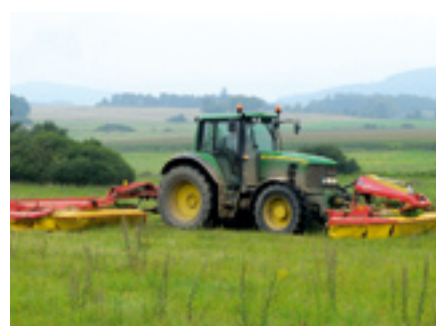
Žací kombinace NOVACAT X 8 ED s prstovým kondicionérem a s pracovním záběrem 8,3 metru nabízí velkou výkonnost a respektuje požadavky na sklizeň kvalitního krmiva. Výborně kopíruje nerovnosti, eliminuje odol a snadno se ovládá.
