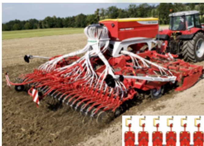
Univerzálny sejací stroj TERRASEM C6 fertilizer. Na menšom snímku je detail dvojdiskových pätiiek Dual-Disc pre sejbu s přihnojováním.
