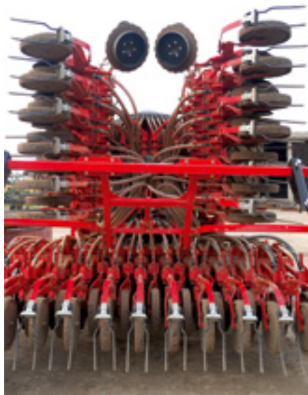
Posledním přírůstkem do strojního parku firmy byl šestimetrový univerzální secí stroj TERRASEM C6 vhodný i pro bezorebné hospodaření na půdě.
