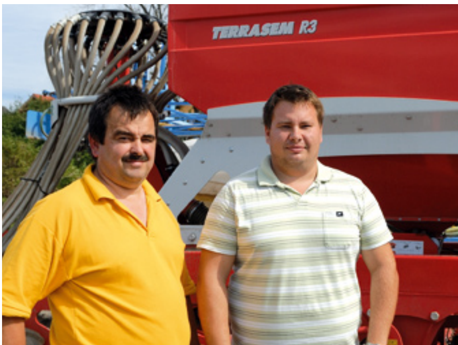
Zľava Ing. Jozef Rusňák so synom. Sejací stroj TERRASEM R3 s pracovným záberom tri metre vhodne dopĺňa diskový podmietač TERRADISC 3000, ktorý pôdu spracováva a pripravuje pre sejací stroj. „Dobre zapravuje rastlinné zvyšky i po kukurici, pekne drobí pôdu a pripravuje ju pre sejbu. Prvé spracovanie je plytšie, druhá podmietačka do hĺbky 12 až 15 cm, a potom už ide sejací stroj. Je to úspornejší postup ako s pluhom,“ hovorí farmár.
