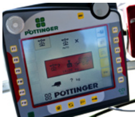
Ovládací panel CCI 100 ISOBUS umožňuje komfortní ovládání vozu JUMBO 10010 L Combiline.
