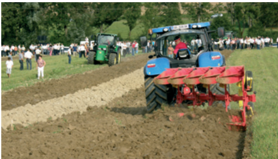
Nesené pluhy SERVO předvedly kvalitní zapravení rostlinné hmoty při pracovní hloubce téměř 30 cm.
