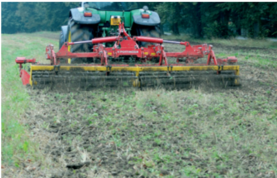
Nesený diskový podmiťáč TERRADISC 5000 K v agregaci s traktorem 220 koní dělal letos 5. září první podmiťku po pšenici ozimé do hloubky 5 až 6 cm. Následovat bude zimní orba a na jaře setí jarního ječmene.
