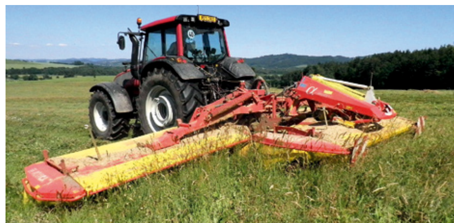
Žací kombinace NOVACAT 8600 a NOVACAT 306 F alpha-motion v agregaci s traktorem Valtra 170 koní s otočným řízením. Denní výkonnost je při optimálních podmínkách až 80 ha. Spotřeba nafty se pohybuje kolem 3,5 až 4,5 litru na hektar.
