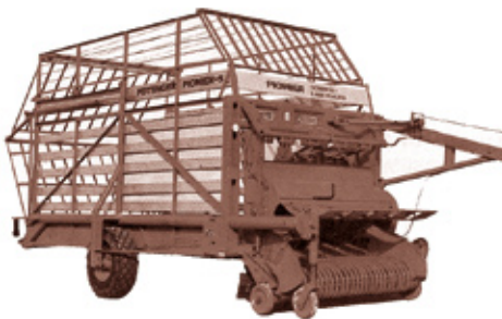
První samosběrací návěs Pöttinger měl označení Pioneer-S. Značně zvýšil výkonnost a snížil pracnost sklizeň. Byl vybaven sběračem a podlahovým dopravníkem pro vyprázdnění hmoty. Uzavřená nástavba měla dřevěné postranice a ve stropní části provazy.
