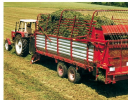
V roce 1972 byl uveden na trh první vůz vybavený řezacím ústrojím ERNTEPROFI 3. V dopravním kanále byl integrován nosník s velkým počtem nožů. Tím mohl návěs sklízet přímo z řádku zelenou píci určenou na krmení. V zadní části byl doplněn o rozdrůzvací válec a zakládací dopravník.
