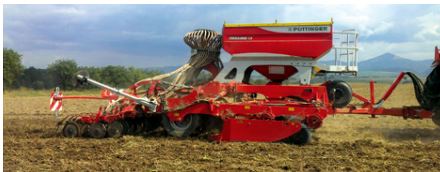
Univerzálny pneumatický sejací stroj TERRASEM C4 Artis slúži v PD Valča tretiu sezónu. Seje celú výmeru repky a obilnín na ploche asi 900 ha a zakladá nové trávne porasty, väčšinou datelinu a datelinotrávy. Každoročne zhruba na štvrtine trávnych porastov zaisťuje ich obnovu. Ovládací panel Artis spĺňa všetky nároky na komfortné ovládanie stroja a kvalitnú sejbu.
