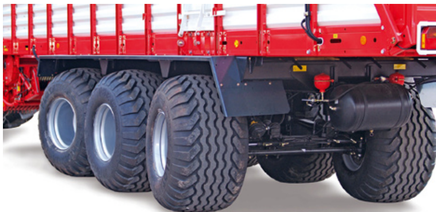
Podvozek Tridem u vozu JUMBO je díky třem nápravám velmi šetrný k půdě, kterou utužuje jen minimálně. Zátěž je rovnoměrně rozložena, což má mimo jiné vliv na vyrovnanou jízdu a úsporu pohonných hmot.
