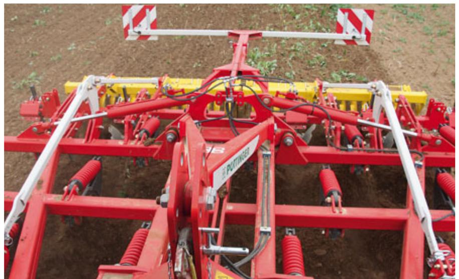
**Bei unserem Test leistete der Synkro 4030 K gute Arbeit sowohl bei flacher als auch bei tiefer Bodenbearbeitung mit jeweils guter Einebnung und Rückverfestigung.**
