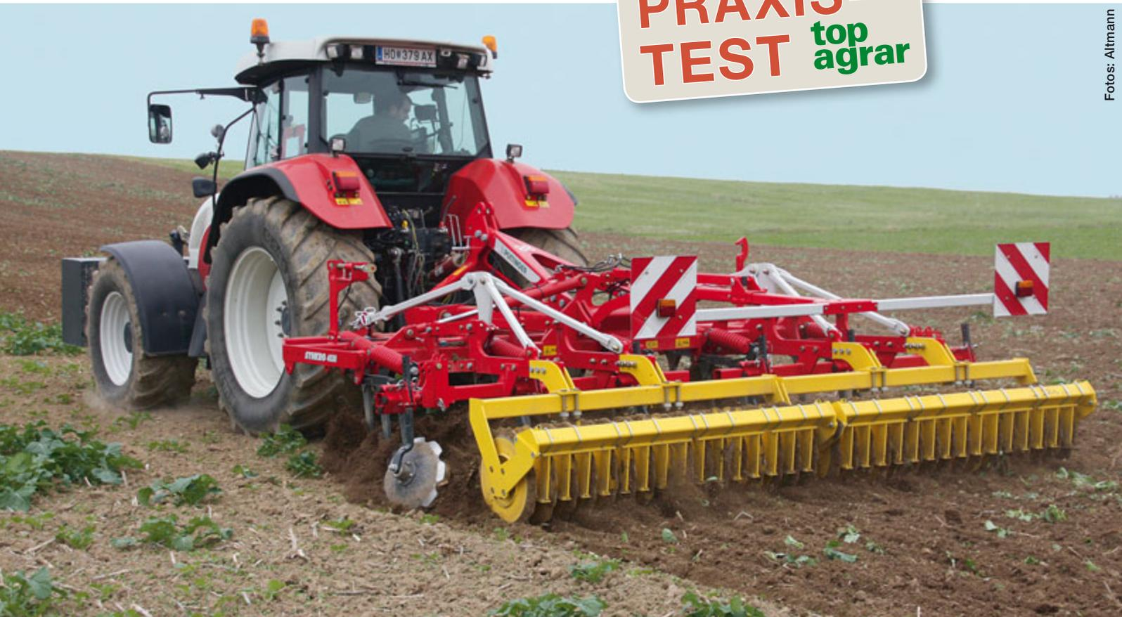
Der dreibalkige Synkro 4030 K mit mechanischer Überlastsicherung und 14 Zinken war mit Meißel- und Flügelscharen ausgerüstet.
