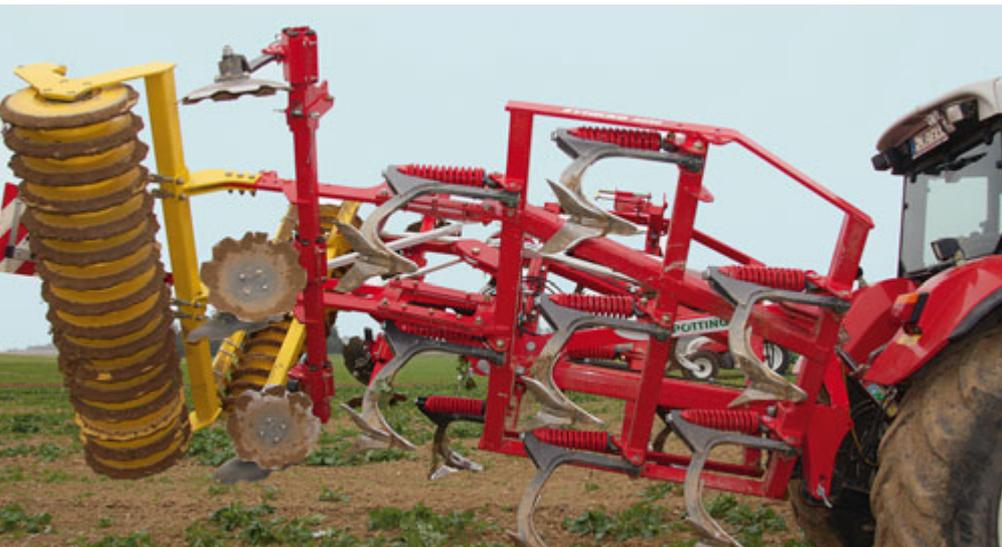
Der Synkro klappt in zwei Hälften. Dabei ver- und entriegelt er automatisch mittels Hydraulikzylinder und Bolzen für einen sicheren Straßentransport.
