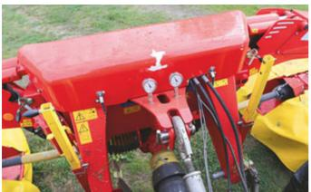
Mit den beiden Hähnen lässt sich das Öl zum Einstellen des Auflagedrucks einzeln an jeder Seite umleiten. Die beiden Zylinder am Ausleger sorgen für die Entlastung und den Aushub am Vorgewende.
