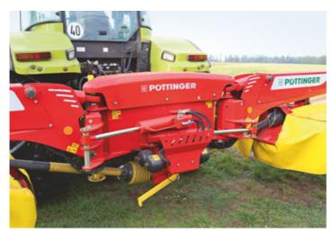
Am Mittelteil sind beide Mähwerksseiten angelenkt. Die beiden Zylinder dienen zum Schwenken in die Transportstellung und auch der Sicherung gegen Überlast.
