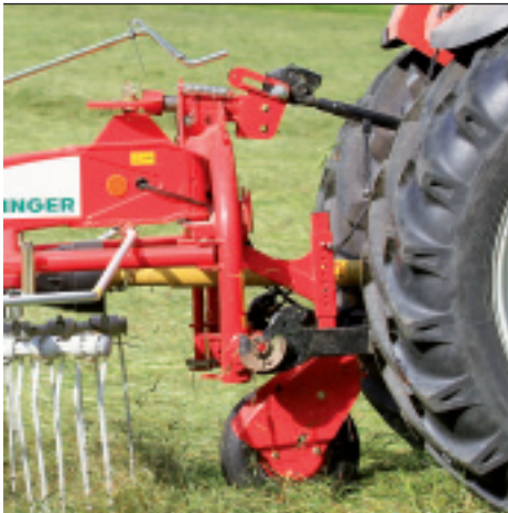
Der überarbeitete Oberlenkeranbau mit optionalem Stützrad, ...
