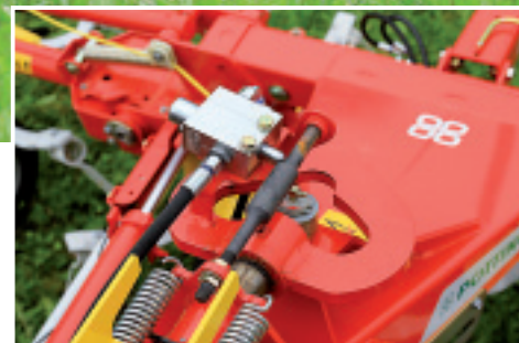
Dieses hydraulische Sperrventil am Schwenkbock sperrt beim 6-Kreislser die äußeren Kreisel beim Ausheben am Vorgewende und ermöglicht dadurch mehr Bodenfreiheit.
