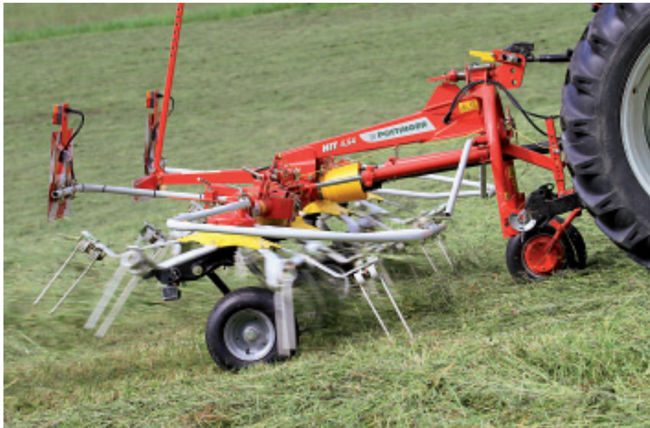
◀ Der überarbeitete Schwenkbock mit Oberlenkeranbau und optionalem Stützrad.
