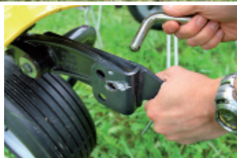
Werkzeuglose Verstellung der Kreiselneigung.
