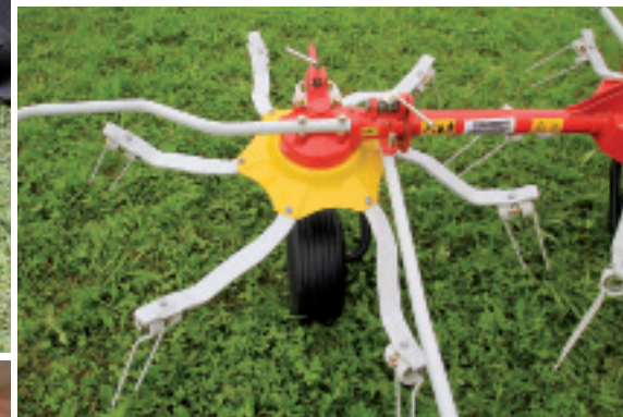
Die neuen „Dynatech“-Kreisel mit gebogenen Zinkenarmen verhindern Futterablagerungen am Kreisel.
