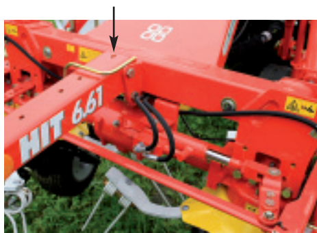
Optionale hydraulisch verstellbare Grenzstreueinrichtung beim HIT 6.61 mit Anzeige (siehe Pfeil).
