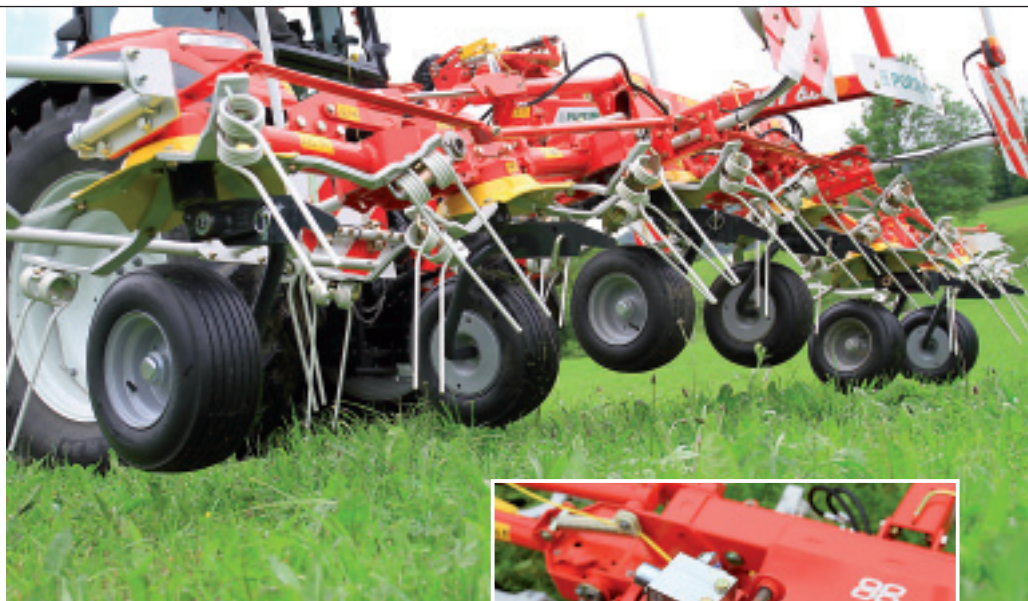
Dieses hydraulische Sperrventil am Schwenkbock sperrt beim 6-Kreislser die äußeren Kreisel beim Ausheben am Vorgewende und ermöglicht dadurch mehr Bodenfreiheit.
